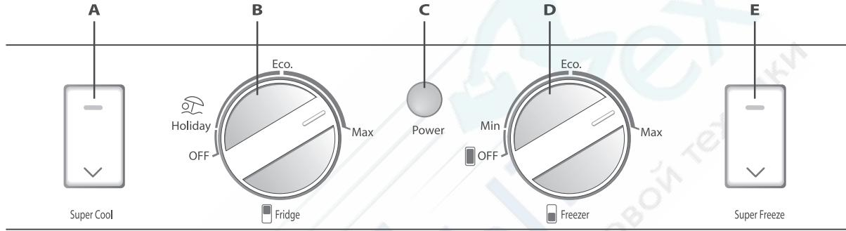
А – кнопка включения режима быстрого охлаждения (обозначение на панели управления SUPER COOL)
